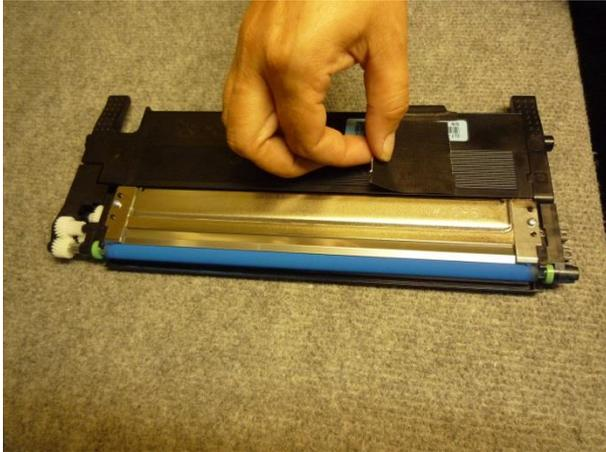
Die Kartusche ist wieder einsatzbereit. Halten Sie die Kartusche möglichst waagrecht beim Einsetzen. So vermeiden Sie, daß Tonerpulver unter dem Klebeband herausrieseln kann.
