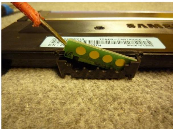
Setzen Sie das abgeschnittene Plastikteil wieder auf und fixieren es mit Klebeband
