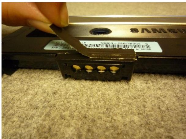
Brennen Sie jetzt mit einem LötKolben ein Loch in die Kartusche. Wenn Sie keinen runden Aufsatz haben genügt auch die Spitze des LötKolbens. Hauptsache das Loch wird groß genug um den Toner einzufüllen. Vermeiden Sie, daß der LötKolben zu tief in das Loch eindringt. Es könnte sonst das Transportband in der Kartusche beschädigt werden.
