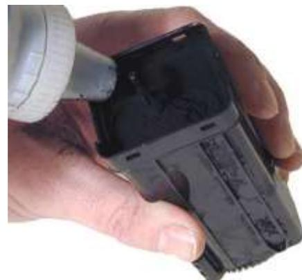
**Nehmen Sie den inneren Deckel ab, entfernen Sie restlichen Toner und füllen Sie den neuen Toner ein.**
