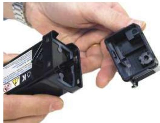
**Mit Hilfe eines kleinen Schraubenziehers nehmen Sie den oberen Deckel ab und entfernen den Resttoner (Staubsauger).**
