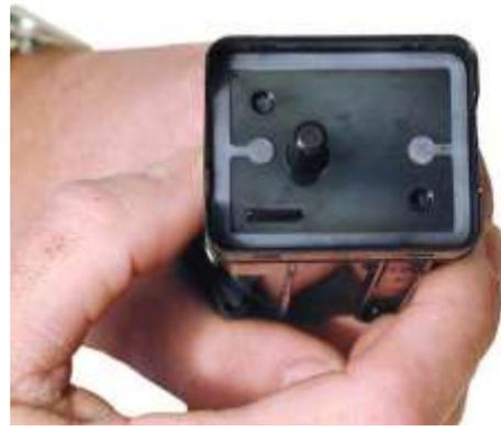
**Reinigen Sie den Sitz des inneren Deckels und setzen Sie den inneren Deckel wieder ein.**
