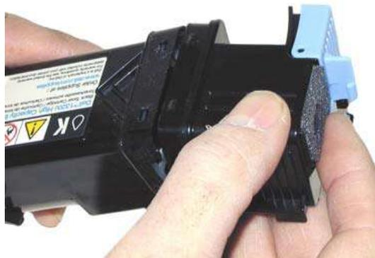
**Setzen Sie den oberen Deckel wieder auf. Achten Sie dabei darauf, dass alle „Nasen“ richtig eingerastet sind und bringen Sie anschließend das Klebeband wieder an.**
