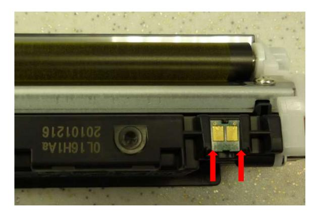
5. Streichen Sie die Chipführung leicht mit etwas Klebstoff ein und setzen den neuen Chip ein.
