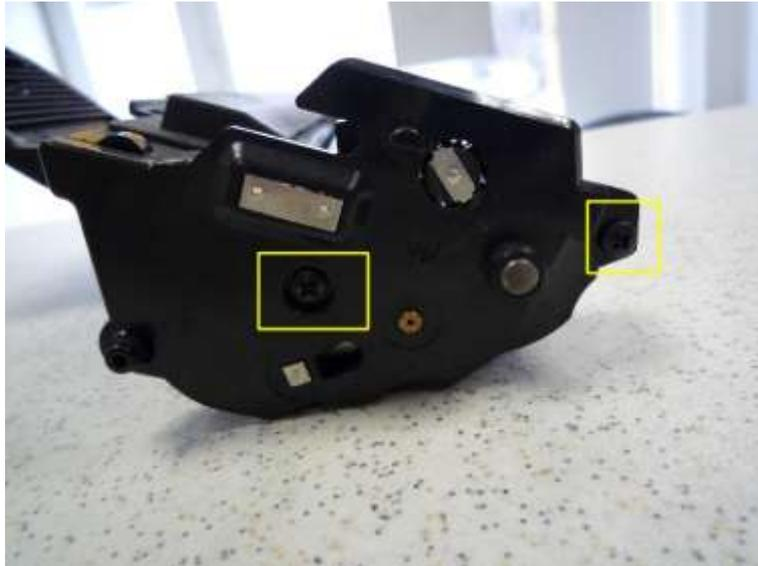
Entfernen Sie jetzt die beiden markierten Schrauben und nehmen Sie den Seitendeckel ab.
