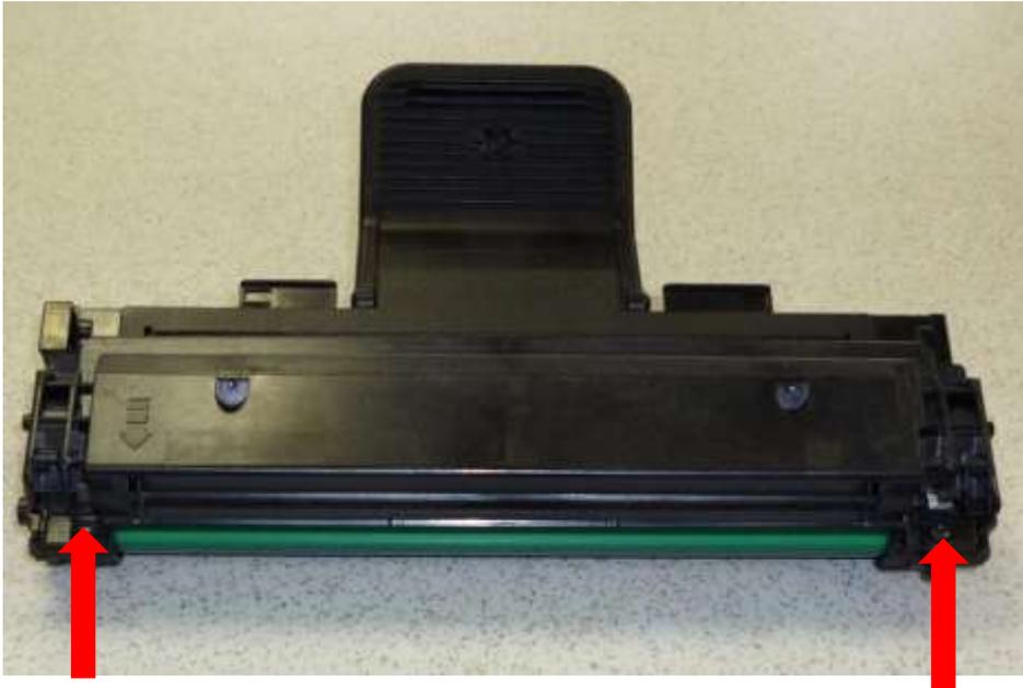
Entfernen Sie die beiden markierten Schrauben und nehmen Sie den oberen Deckel ab.
