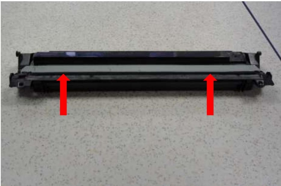
Schütten Sie den Resttoner aus dem Deckel und klopfen Sie ihn gut aus. Reinigen Sie danach die Kartusche und den Deckel vorsichtig mit einem Staubsauger.
