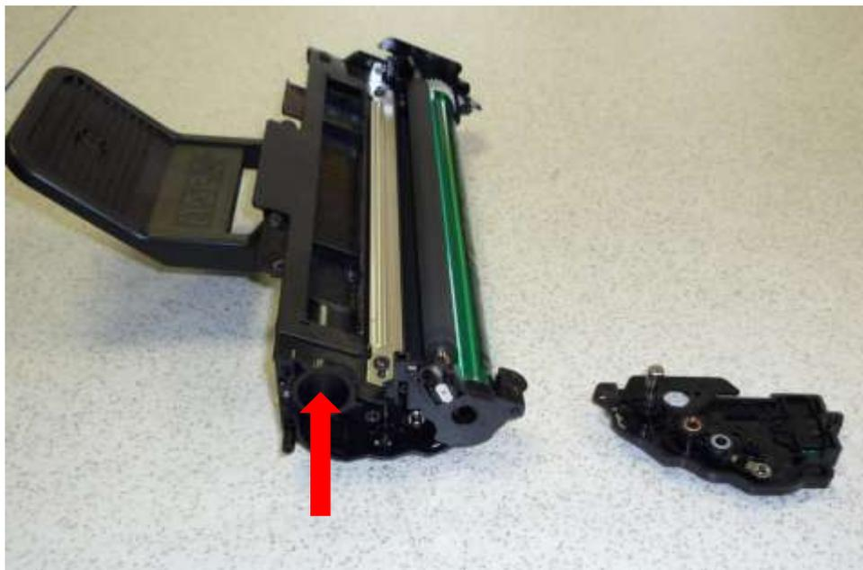
Entfernen Sie den Verschlussstopfen, schütten Sie den restlichen Toner aus, füllen Sie den neuen Toner ein und setzen Sie den Verschlussstopfen wieder ein.
