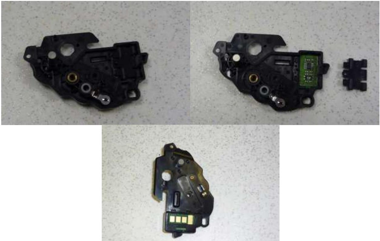
Jetzt kann die Kartusche wieder zusammengesetzt werden. Setzen Sie zuerst den Seitendeckel ein und schrauben ihn fest. Danach setzen Sie den oberen Deckel auf und befestigen ihn mithilfe der Schrauben.
