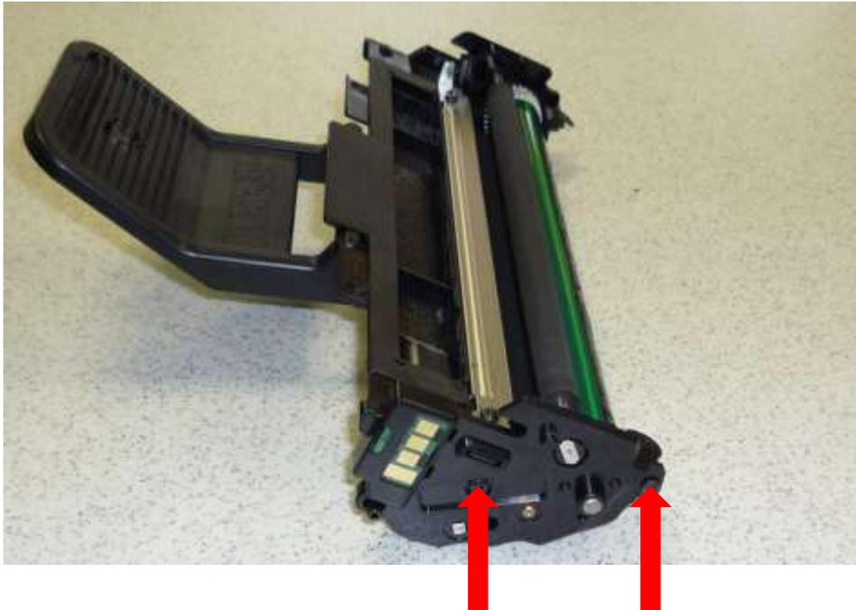
Entfernen Sie jetzt die beiden markierten Schrauben und nehmen Sie den Seitendeckel ab.
