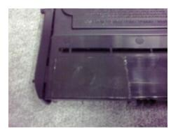
Brennen Sie an der gezeigten Stelle mit einem Lötkolben ein ca. 10mm breites Loch in die Kartusche.
