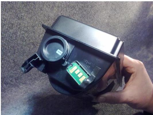
Brennen Sie an der markierten Stelle mit einem Lötkolben ein ca. 10mm großes Loch in die Kartusche. Entfernen Sie den alten Toner aus der Kartusche und füllen Sie den neuen Toner ein. Anschließend das Loch mit Gewebeband verschließen.
