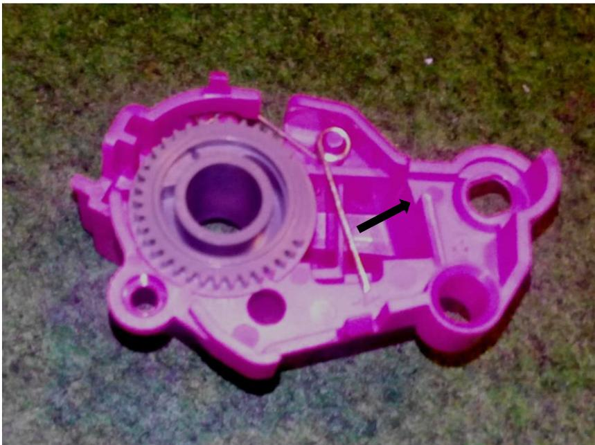
Setzen Sie die Feder auf ohne sie zu spannen. Danach setzen Sie den „Resethebel“ ein.
