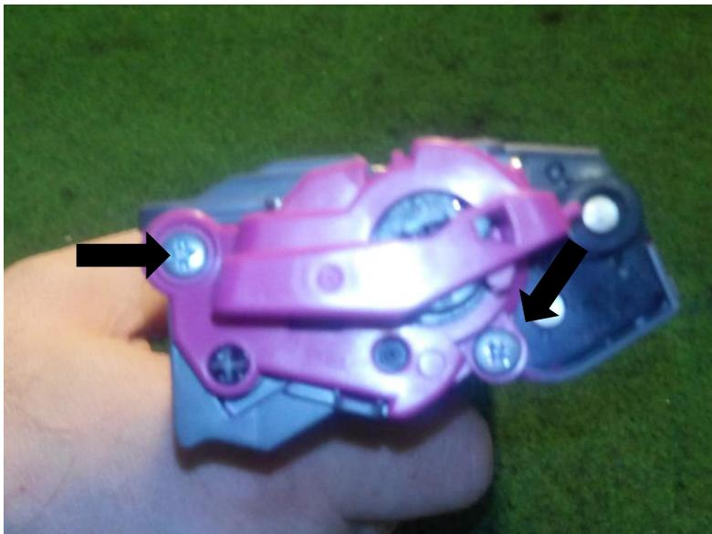
Entfernen Sie die beiden Schrauben und nehmen Sie den Seitendeckel ab.
