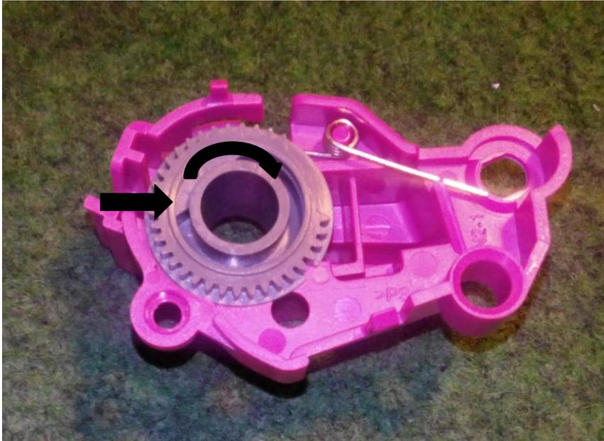
Jetzt drehen Sie den „Resethebel“ bis zum Anschlag im Uhrzeigersinn.
