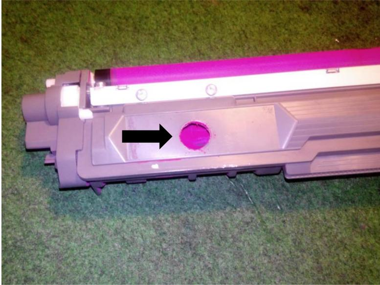
Entfernen Sie das Etikett auf der Kartusche und brennen Sie mit einem Lötkolben oder unserem Lochbrenner ein Loch in die Kartusche.
