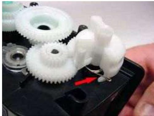
Nun setzen Sie die Endkappe wieder auf die Kartusche und befestigen die 2 Schrauben. Befindet sich das Reseträdchen in derselben Stellung wie abgebildet, ist die Kartusche einsatzbereit und kann wieder in das betreffende Gerät eingesetzt werden.
