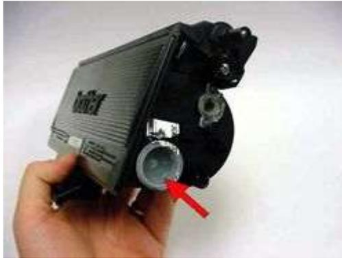
Nachdem Sie das Resttonerpulver aus der Kartusche entfernt haben, können Sie nun mit dem eigentlichen Nachfüllen beginnen. Schütten Sie hierzu das Tonerpulver in die Kartusche. Nachdem Sie die Kartusche befüllt haben, verschließen Sie sie wieder mit dem vorher entfernten Verschlussdeckel.
