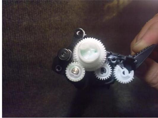
Drehen Sie das Resetrad in die angezeigte Position. (siehe Bild)
